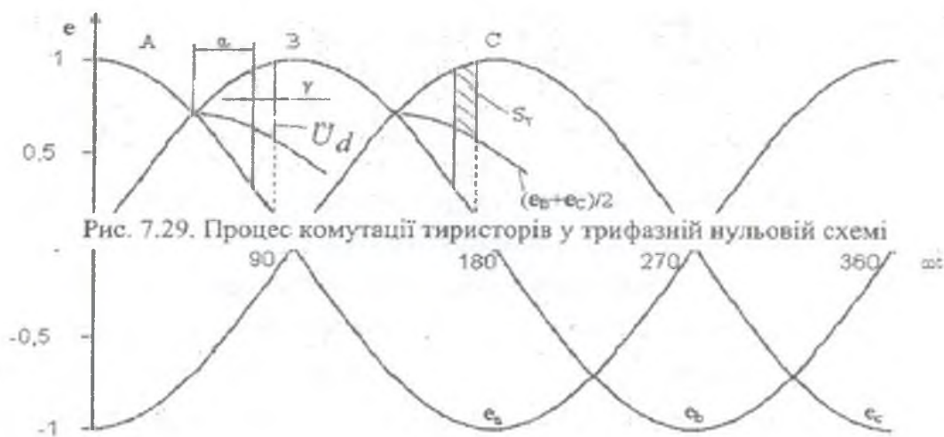
Рис. 7.29. Процес комутації тиристорів у трифазній нульовій схемі
